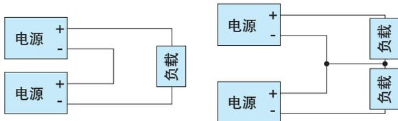
图2.1 串联运行连接示例
