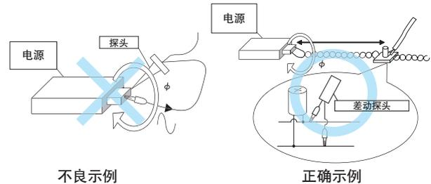
图1.2 输出纹波噪声的测量示例
