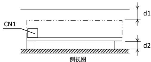
■初级侧存在AC电压。因此，为防止触电及满足泄漏电流的安全标准要求，应确保适当的绝缘距离。
