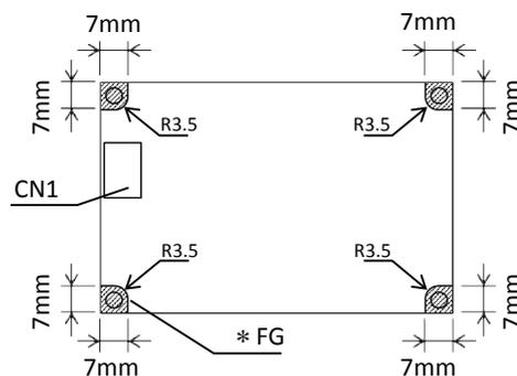
\* 建议将FG电气连接至金属底架上以降低噪声。
