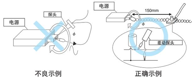
图1.2 输出纹波噪声的测量示例
